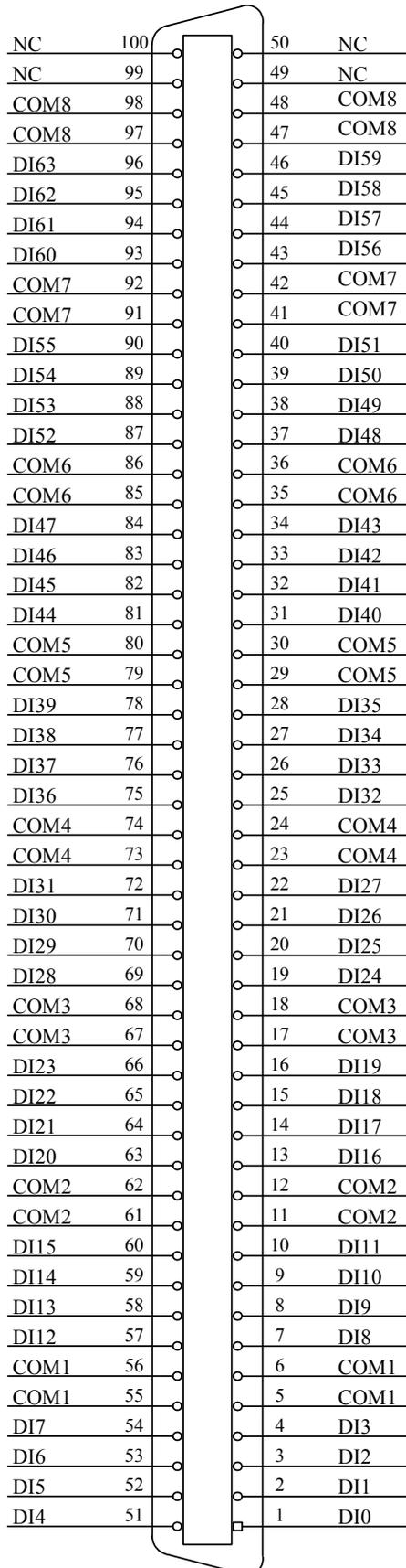
关于 100 芯 SCSI 型插头 CN1 的管脚定义（表格方式）
