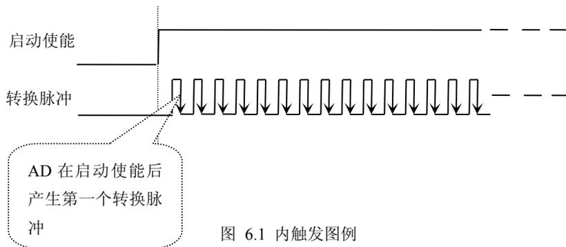
图 6.1 内触发图例
