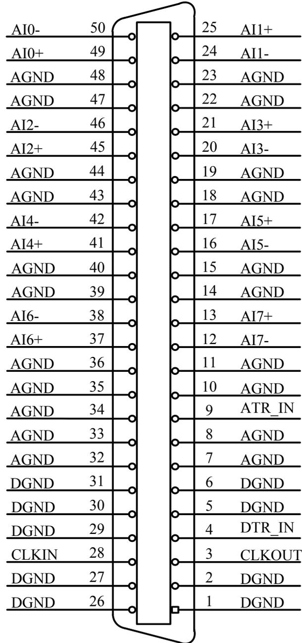
关于50芯SCSI插头CN1的管脚定义（表格方式）
