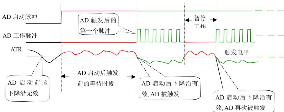
图 6.4 低电平触发
