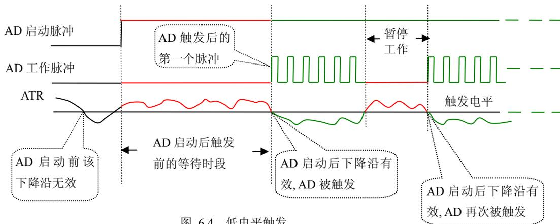
图 6.4 低电平触发
