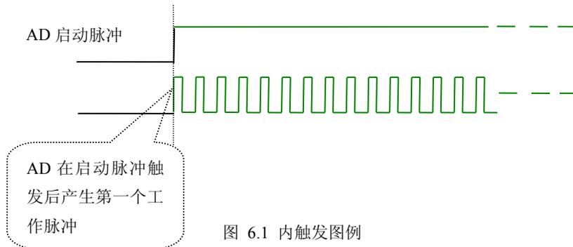
图 6.1 内触发图例
