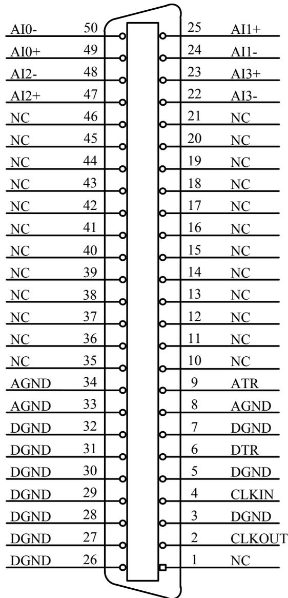
关于50芯SXXSI型插头CN1的管脚定义（表格方式）
