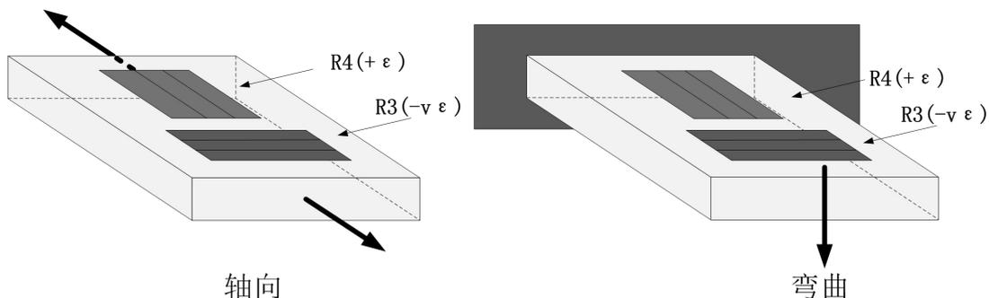
图 5.2.5 半桥 I 测量轴向和弯曲应变
