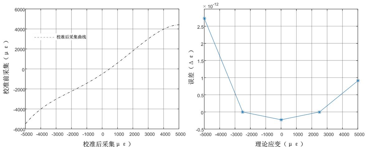
图 6.3.2 校准后应变片采集及误差曲线
