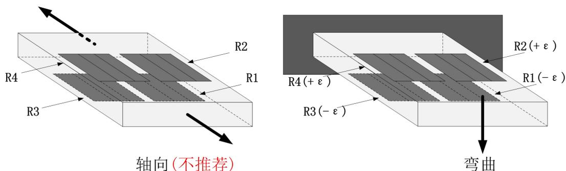
图 5.2.9 全桥 I 测量弯曲应变
