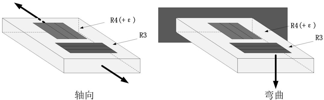
图 5.2.3 1/4 桥 II 测量轴向和弯曲应变
