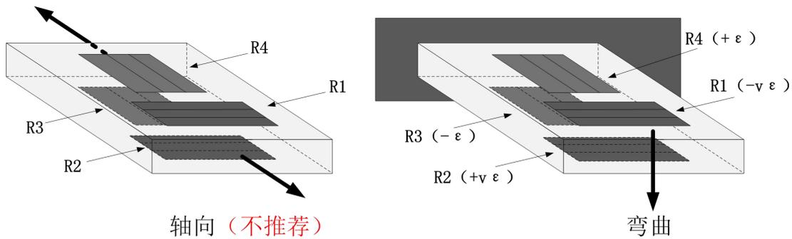
图 5.2.11 全桥 II 测量弯曲应变
