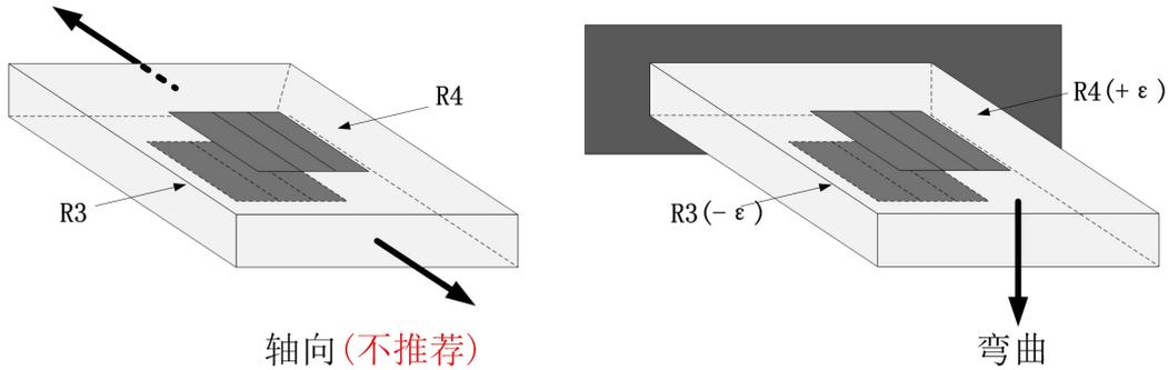
图 5.2.7 半桥 II 测量弯曲应变
