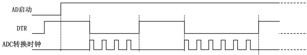
图 4.7.4 暂停触发—高电平暂停
