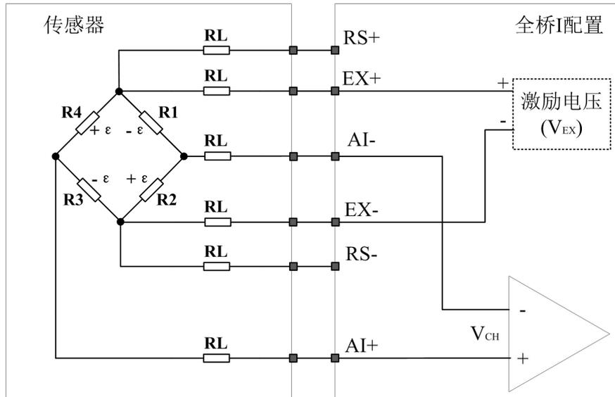
图 5.3.1 力、压力和扭矩传感器的电路
