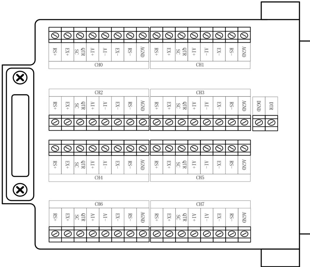
图 3.3.2 TB8720 端子引脚定义
