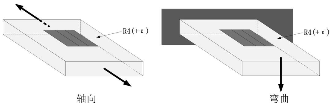
图 5.2.1 1/4 桥 I 测量轴向和弯曲应变
