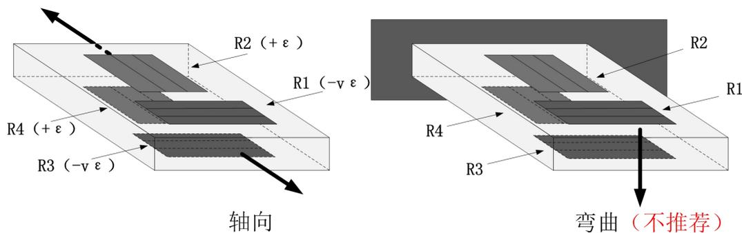
图 5.2.13 全桥 III 测量轴向应变
