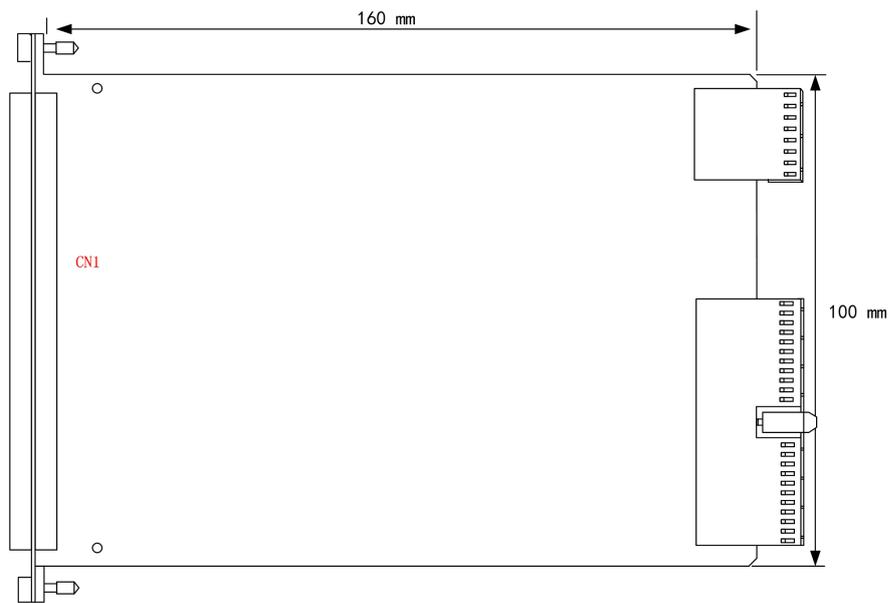
图 3.2.1 PXI8720 板卡尺寸图
