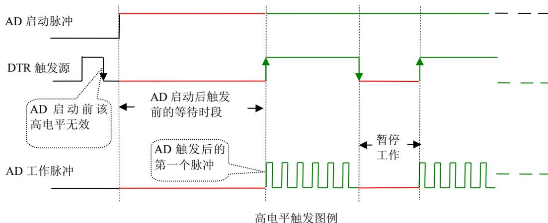
当ADPara.TriggerDir = PXI8305\_TRIGDIR\_POSIT\_NEGAT时，即选择触发方向为正负向触发。它的原理与内部软件触发同理。
